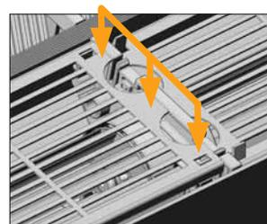
Разомкните защитную решетку. Для этого нажмите одновременно на оба зажима в направлении стрелок, одновременно легко выталкивая решетку вверх из фиксатора. Те же действия произведите на другой стороне решетки.
