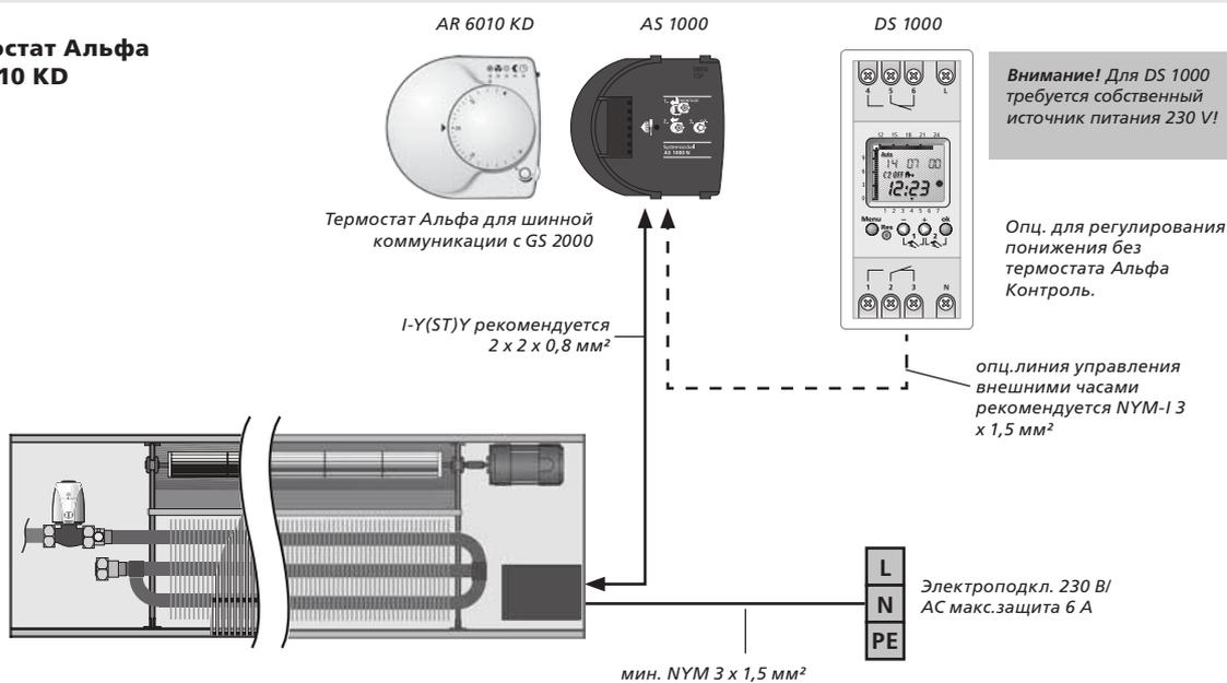
Посредством переключательного сигнала внешнего дигитального таймера можно активировать режим понижения температуры.
