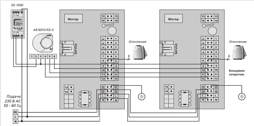
Все QSK должны быть подключены параллельно. Кольцевое или звездообразное подключение недопустимо. Нагрузочный ток в том же проводе не должен превышать 6 А! В зависимости от условий места возможно при необходимости предусмотреть дальнейшие питающие магистрали!
